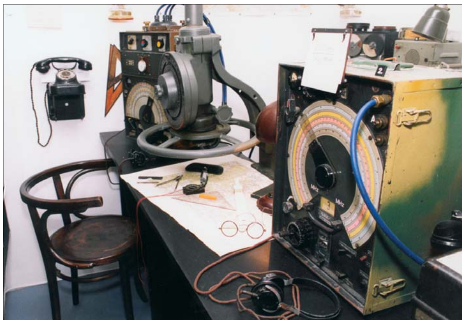
Součástí vybavy rádiové zaměřovací služby byl goniometrický přijímač EP 2 se stacionárním zaměřovacím zařízením a odposlechový krátkovlnný přijímač Fu.H.Ec.
