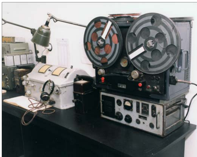
K přijímání a zaznamenávání zpráv ilegálních vysílaček sloužil krátkovlnný přijímač Spez. 860 Bs. a magnetofofon AEG, typ Ton.S.b.
