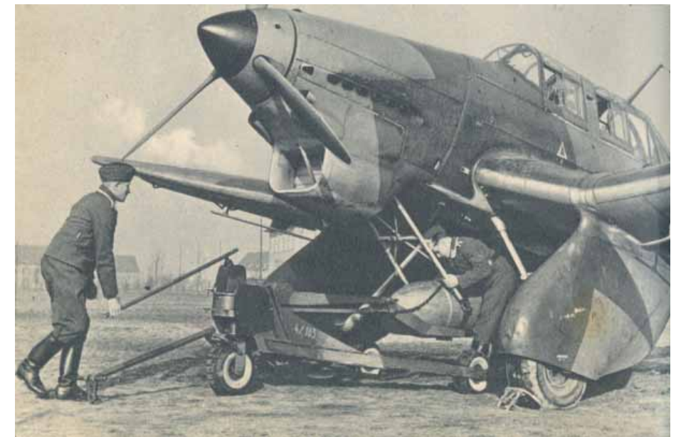
Zbrojírňi zavěšují pumu na hrazdu pod Ju 87 Stuka.
