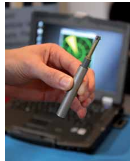
Senzor pro lokalizaci střelby společnosti Microflown Technologies
