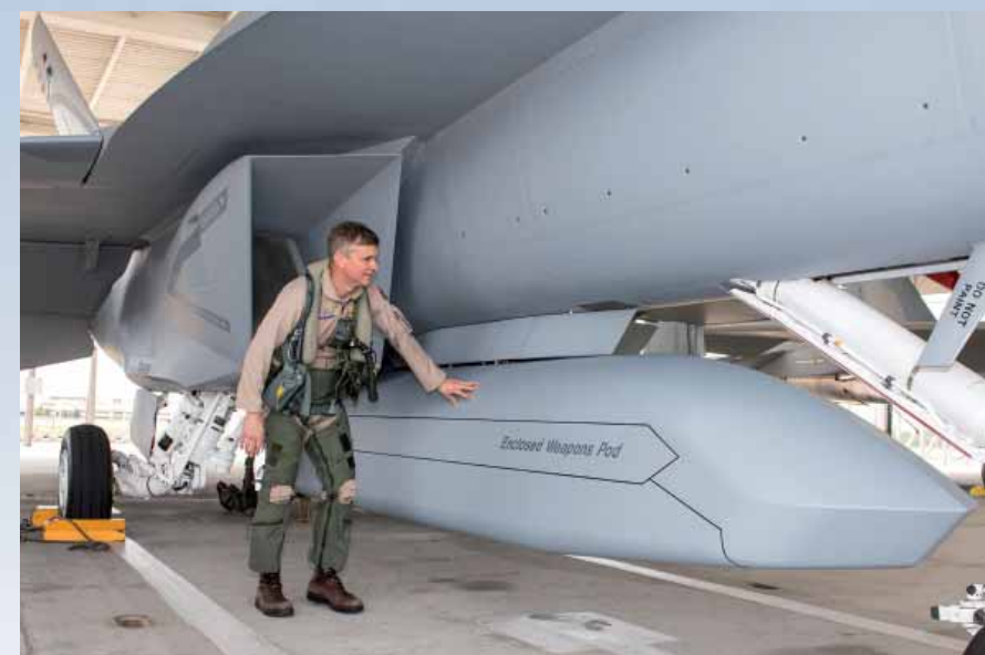
NOVÝ ZBRANOVÝ KONTEJNER EWP (ENCLOSED WEAPONS POD), ZAVĚŠENÝ POD TRUPEM ADVANCED SUPER HORNETU
