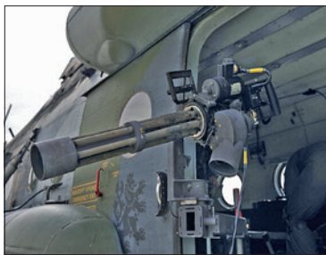
Kulomet Dillon M134D-H Mini Gun na vrtulníku
