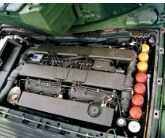
Detailní pohled na napříč uložený motor
