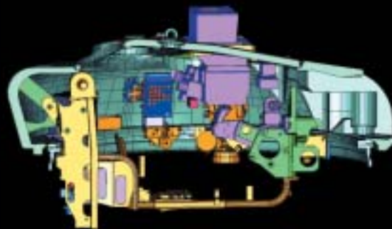
Řez levou polovinou věže s porovnáním stavu před a po zástavbě nového vybavení
