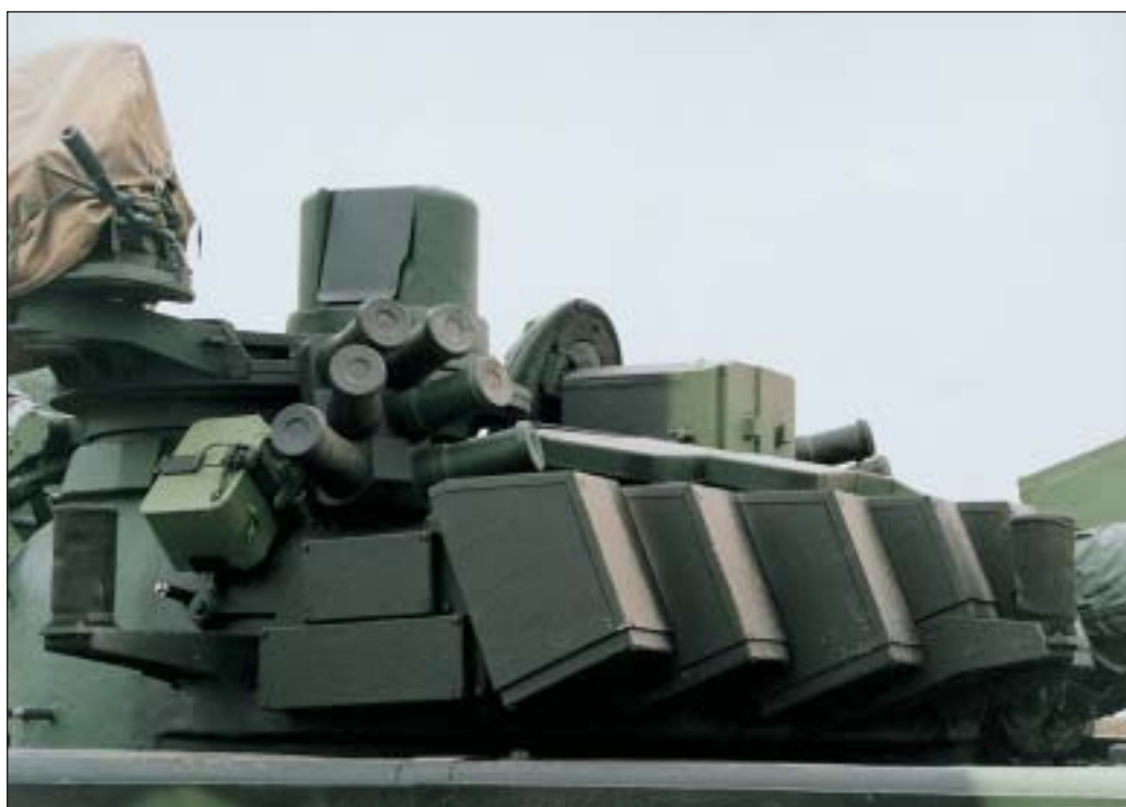
Zaměřovač velitele s ochranným krytem. Pod ním jsou vrhače zážymovacích granátů.
