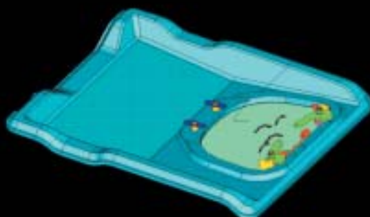
Nový a odolnější díl dna korby pod řidičem
