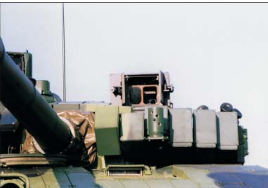
Zaměřovač střelce. Pod ním je před bloky dynamické ochrany vidět indikátor laserového ozáření.
