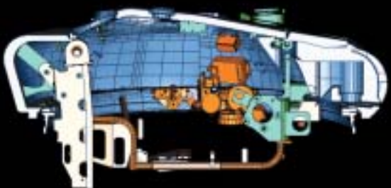
Řez levou polovinou věže s porovnáním stavu před a po zástavbě nového vybavení
