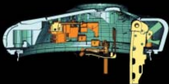
Řez pravou polovinou věže s porovnáním stavu před a po zástavbě nového vybavení
