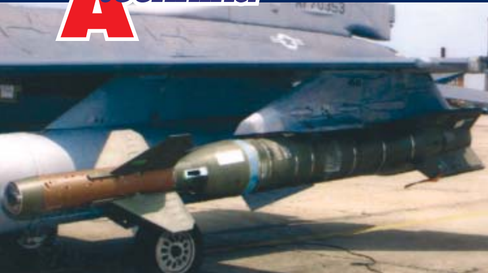
Vylepšená puma EGBU-27 může být použita i v případě, že spojnice mezi soazkem laserové energie odráženým od cíle a hlavici pumy narušuje příkrov mraků nebo dým.
