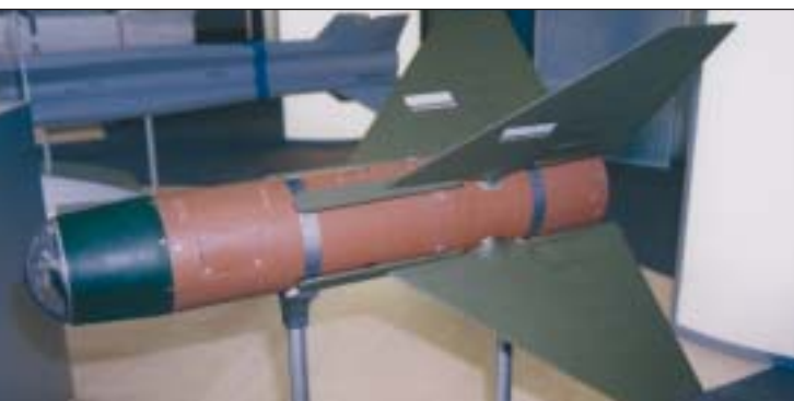
Přední část sady PAVEWAY III s předovým senzorem a pohyblivými řídicími aerodynamickými plochami
