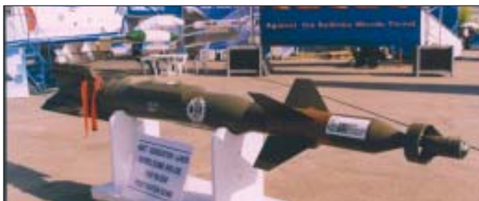
Izraelský laserem naváděný typ NG-LGB, jehož bojovou část tvoří průbojná puma PB-500.
