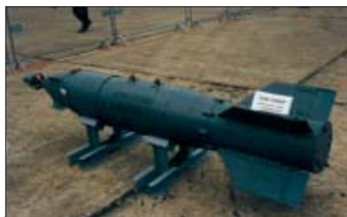
Ruská laserem naváděná puma KAB-500L. Na rozdíl od všech ostatních typů nemá řídicí aerodynamické plochy na přední, ale na zádi. Na snímku jsou dobře vidět pohyblivé kormidla na konci křížových ploch.
