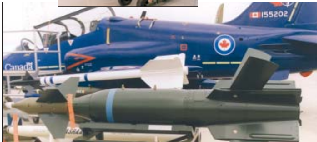
Průbojná hlavice BLU-109 tvoří bojovou část několika typů přesně naváděné letecké munice. Má délku 2,4 m, průměr těla 0,37 m a hmotnost 875 kg, z čehož 240 kg připadá na trhavinu.
