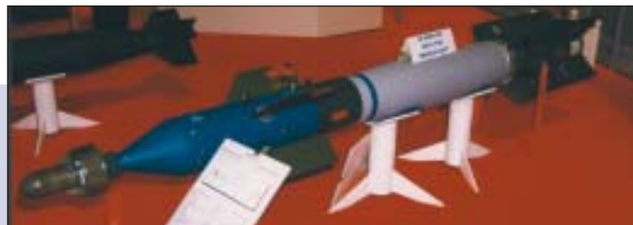
Puma PAVEWAY III GBU-22 má bojovou část o hmotnosti 227 kg.
