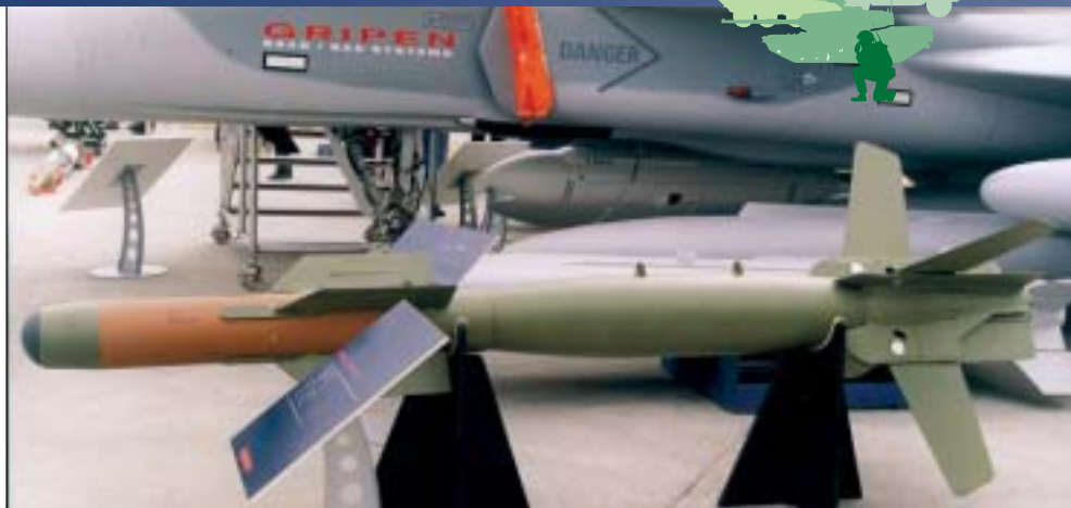
Puma PAVEWAY III GBU-22 má bojovou část o hmotnosti 227 kg.
