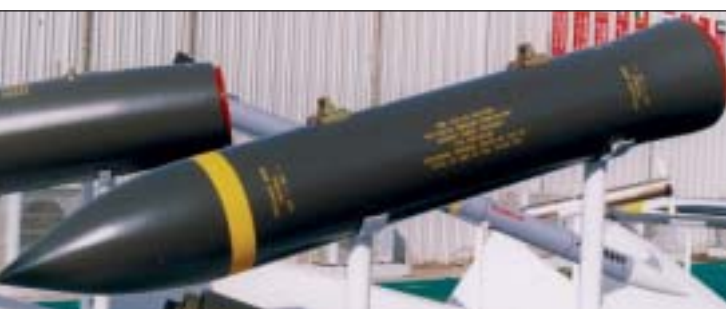
Průbojná hlavice BLU-109 tvoří bojovou část několika typů přesně naváděné letecké munice. Má délku 2,4 m, průměr těla 0,37 m a hmotnost 875 kg, z čehož 240 kg připadá na trhavinu.
