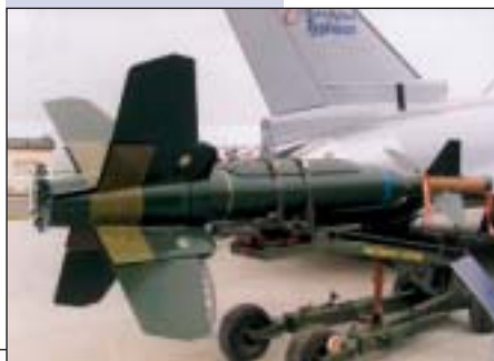
Britská puma Mk18/20 s naváděcím systémem PAVEWAY II (spodní snímek) a „těžší“ provedení (bojová část o hmotnosti 907 kg) se systémem PAVEWAY III
