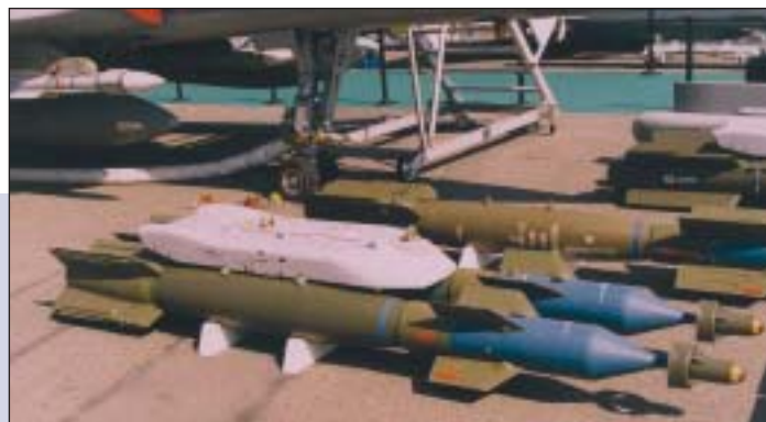
Izraelský laserem naváděný typ NG-LGB, jehož bojovou část tvoří průbojná puma PB-500.
