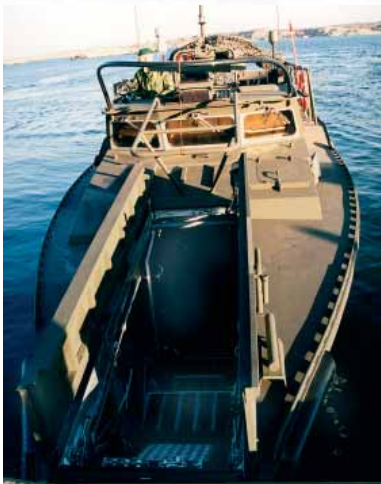
Sklopná příďová rampa spolu s otevřenou horní částí paluby umožňuje vyloďení 21 vojáků během 60 sekund. Další snímek pořízený z uvnitř člunu naopak ukazuje vyloďovací rampu v uzavřené poloze.
