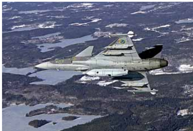
GRIPEN s novým taktickým průzkumným kontejnerem MRPS (SPK-39), který je 4,5 m dlouhý a má typickou hmotnost 680 kg.
