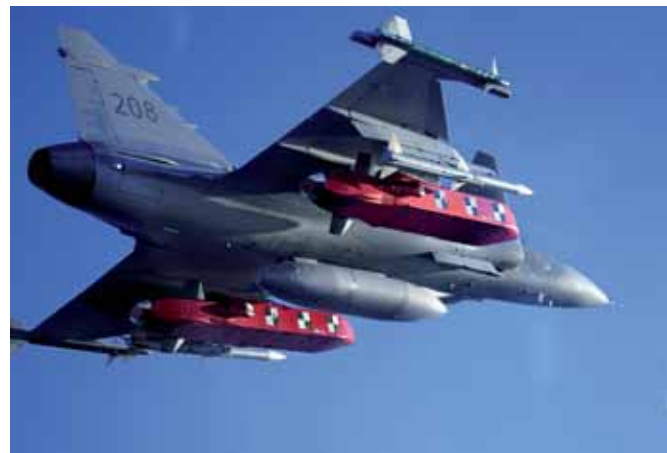
GRIPEN s dvojicí nejnovějších mohutných protizemních řízených střel s plochou dráhou letu TAURUS KEPD 350, z nichž každá má hmotnost asi 1400 kg a dolet až 350 km.
